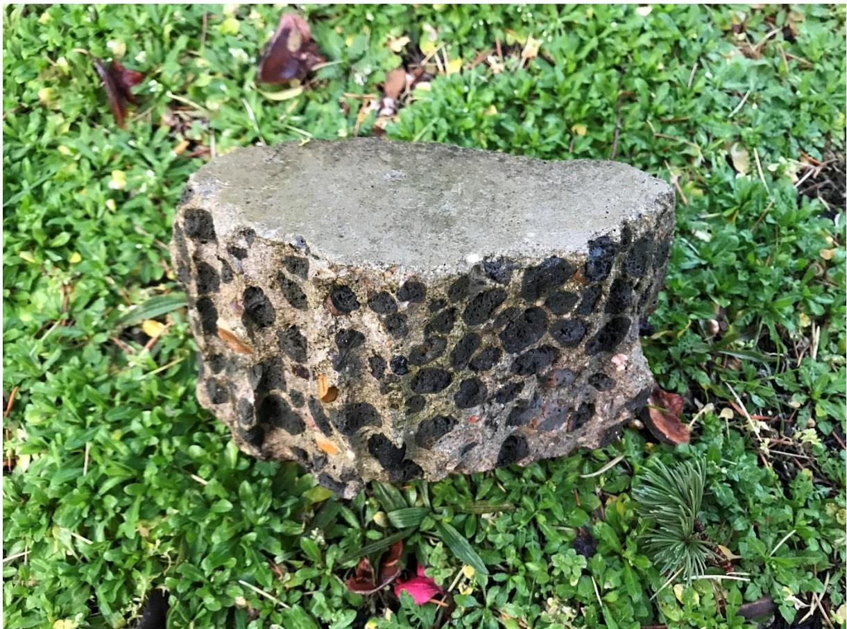
*Photo 8 Béton avec insertion de billes d'argile expansé photo fournie par Jean-Jacques Proquez*
